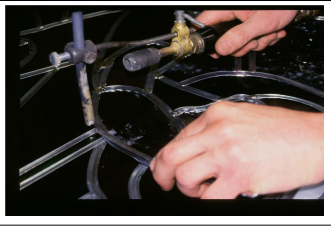
De verbindingen van het loodprofiel voor en achter solderen met tinsoldeer.
