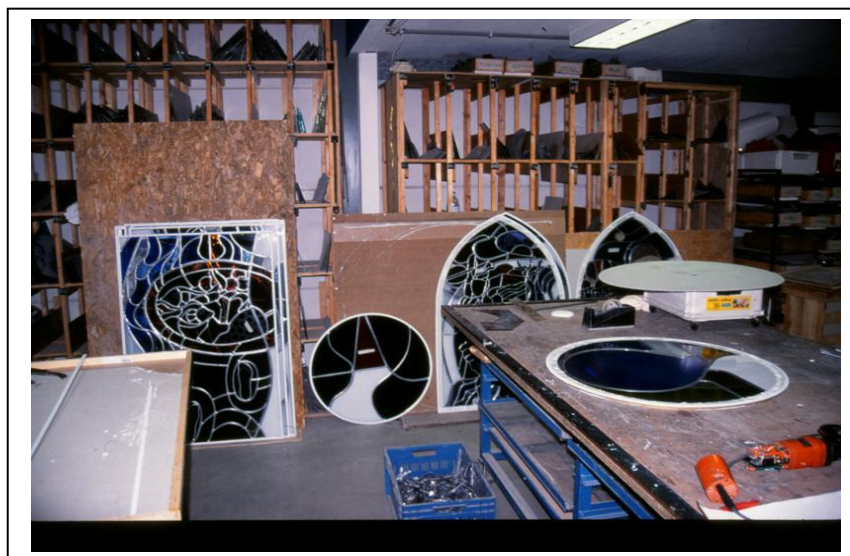
Een aantal ramen is klaar met messingprofiel en verstevigingsroede. Eén zijde wordt dicht gekit en het raam wordt met beukenhoutzaagsel schoon gemaakt.
